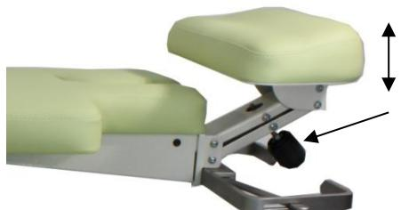
Le fauteuil ak 5010 est équipé d'un repose-tête réglable en continu (max. 20 kg), qui soutient très confortablement la tête en position latérale (park bench). Le bouton rotatif (indiqué par la flèche) permet de le déplacer vers le haut ou vers le bas.
