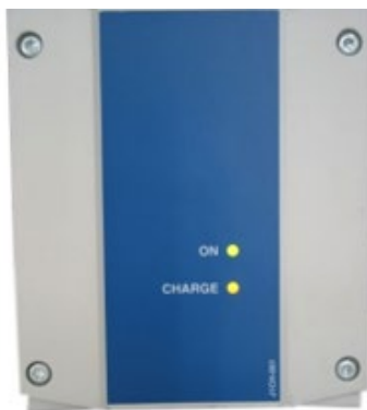
ON = indicator luminos PORNIT CHARGE = indicator luminos ÎNCĂRCARE
