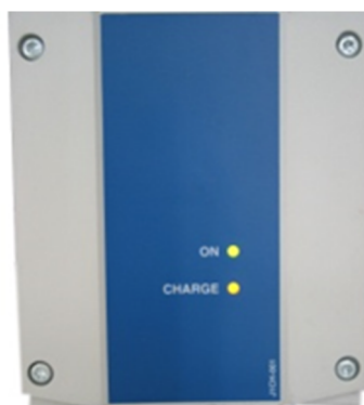
ON = Mise sous tension CHARGE = batterie en cours de charge
