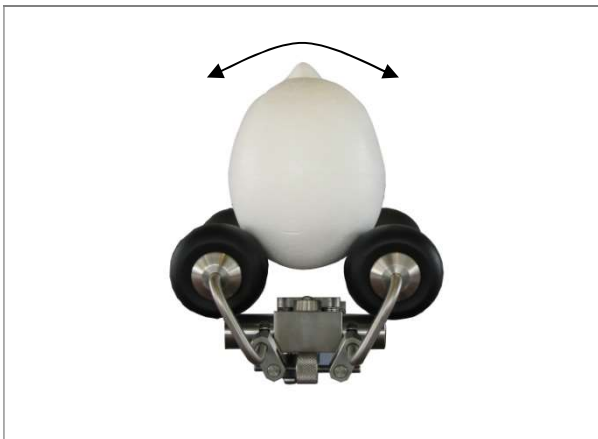
Fig. 29 Positionierung des Kopfes auf der Stütze
